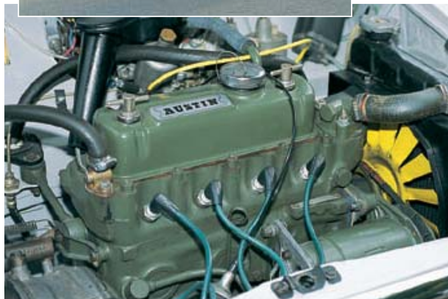
Millers Oils hat für die Motor-Getriebe-Einheit des kleinen Frontrieblers ein Öl namens Transverse 20W 50 maßgeschneidert. Es ist besonders unempfindlich gegen die Scherkräfte zwischen den Gangrädern
