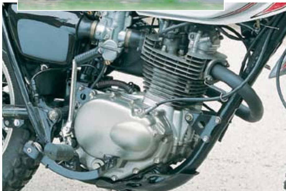
Für den japanischen Viertakter empfiehlt Millers Oils dasselbe Transverse 20W 50 wie für den Mini, denn auch hier läuft das Getriebe – wie bei vielen modernen Zweirädern – im Motoröl
